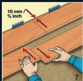
Zum Rückbau komplette Dielenreihe aus der vorderen Reihe ausheben, anschließend einzelne Elemente auseinander schieben
